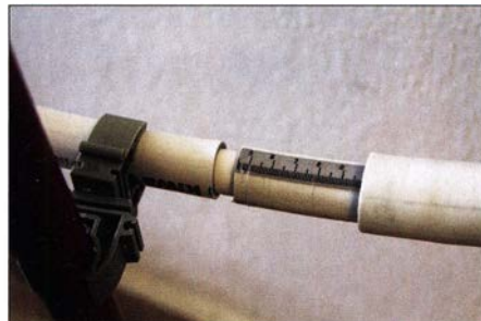
Bild 5: Die zweite Möglichkeit zum Feinabgleich besteht darin, ein dickeres Rohrstück (rechts) nahe der Lücke zu positionieren.
