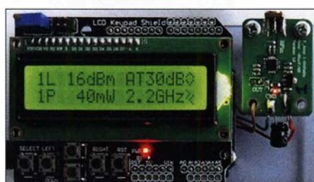
Bild 2: Arduino Uno mit aufgestecktem LCD Keypad Shield und zwei übereinander angeordneten AD8318-Modulen
