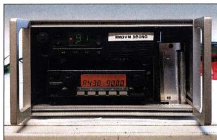
Umbau von DB0NG zu einem MMDVM-Repeater Foto: YBL
