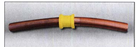
Bild 7: Eines der in diesem Fall aus Kupferrohr hergestellten Abgleichstücke mit dem Distanzring Fotos: OK2ER
