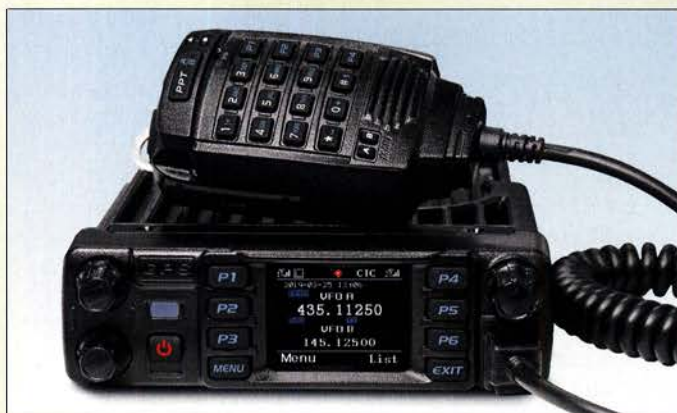
Twinband-Mobilfunkgerät Anytone AT-D578UV Pro samt des zum Lieferumfang gehörenden Handmikrofons mit 10er-Tastatur und Up-/Down-Tasten
