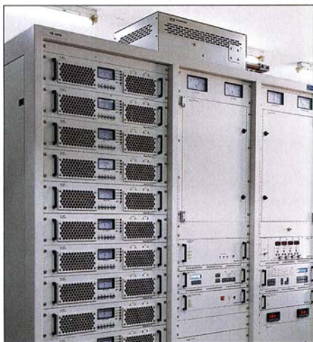
Der neue 10-kW-Sender aus Südkorea ermöglicht einen schnellen Wechsel zwischen 3945 kHz, 5040 kHz und 7260 kHz.
