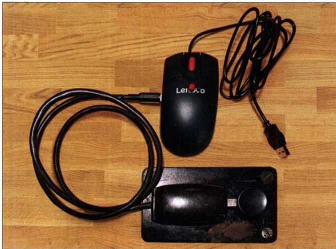
Bild 1: Eine ausgediente USB-PC-Maus kann als Adapter für eine einfache Hubtaste noch gute Dienste leisten. Auch der Tastausgang einer Elbug-Elektronik ist hier anschließbar.
