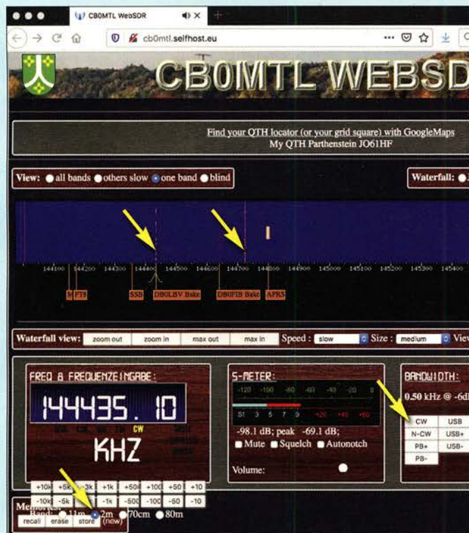
Bild 4: Wenn in Nähe einer Bake, hier DBOLBV und DBOFIB, ein Web-SDR stationiert ist, das im 2-m-Band den Bakenbereich mit abdeckt, kann man sich auf diesem Weg einen Eindruck verschaffen.
