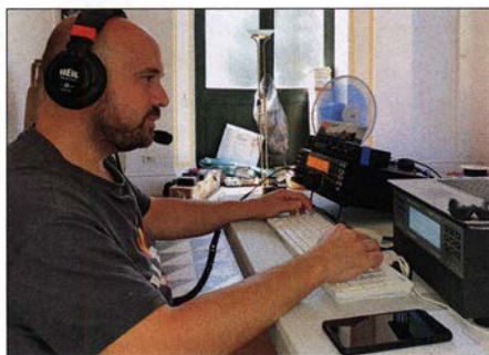
Raúl, EA5KA, an einem typischen Funkarbeitsplatz mit Elecraft K3, Micro Keyer II und Endstufe SPE Expert 1.3K
