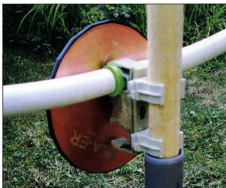
Bild 4: Abgleichplatte, die an einer Schelle über der nach dem Einschieben der kurzen Rohre verbleibenden Lücke sitzt
