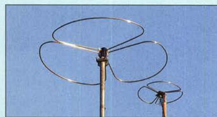
Bild 5: Big-Wheel-Antennen für 2 m (links) und 70 cm – solche horizontalen Rundstrahlantennen kommen häufig bei Baken zum Einsatz.
