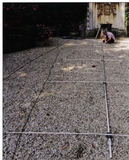
Aufbau der 6-m-Yagi-Antenne im Garten der Villa
