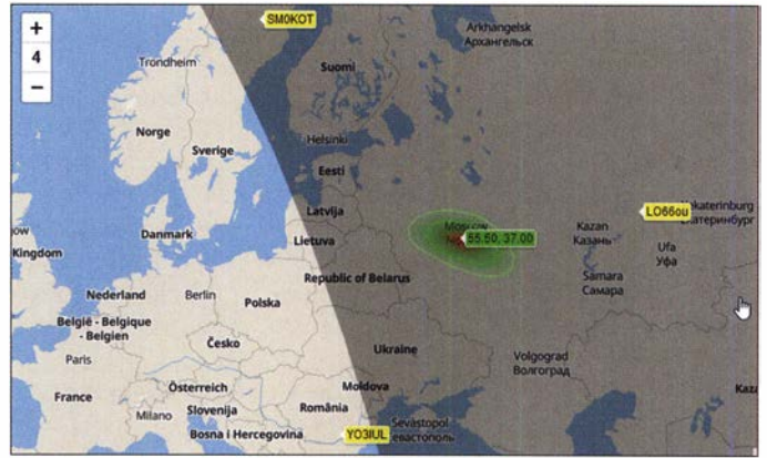
Bild 4: ... bis sich eine möglichst kleine und scharf umrissene Peillinse bildet. Die Software zeigt automatisch die geografischen Koordinaten der wahrscheinlichsten Position an.
