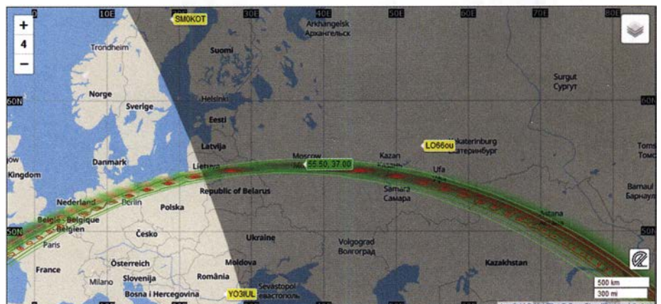
Bild 2: Für zuverlässige Peilungen sollte sich der Sender innerhalb eines Dreiecks von Empfängern befinden. Da der Standort nicht bekannt ist, muss man sich zumeist an ihn herantasten, wobei man nur Stationspaare mit relativ schmalen Hyperbeln nimmt...
